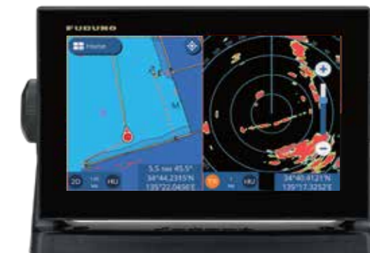
Беспроводное соединение DRS4W и GP-1871F/GP-1971F
