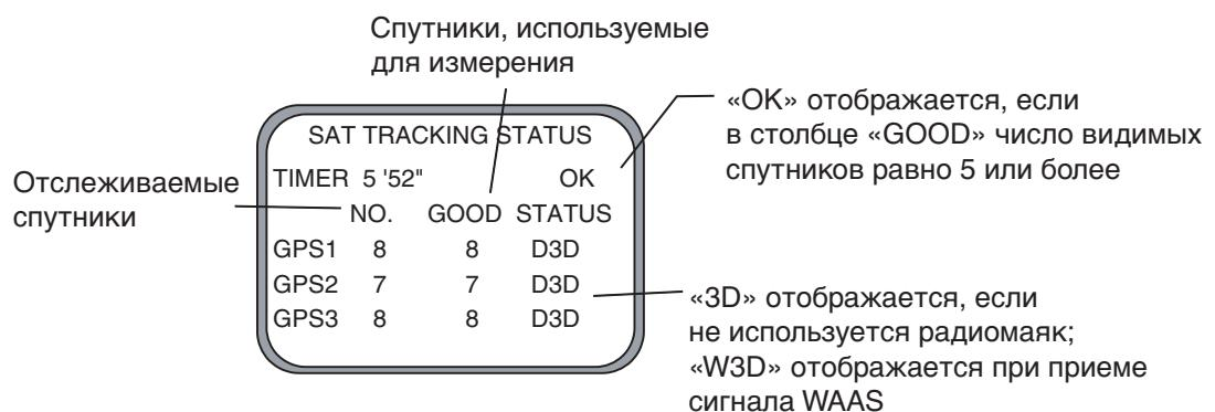
*Экран статуса приема спутникового сигнала*
